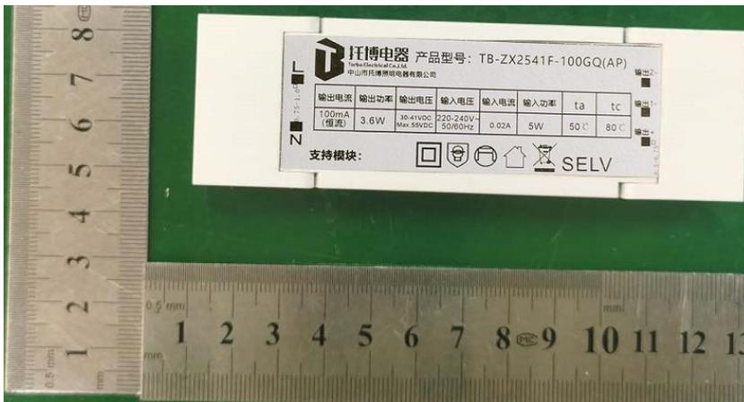
辅检型号: TB-ZX2541F-100GQ (AP) 输出: 恒流 100mA, 30-41VDC, Max. 55VDC, 输出功率: 3.6W
